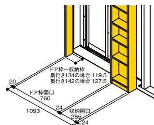
ドア横に取付けスペースが必要となります。間柱などの障害物は取付けスペースを避けて設置してください。
